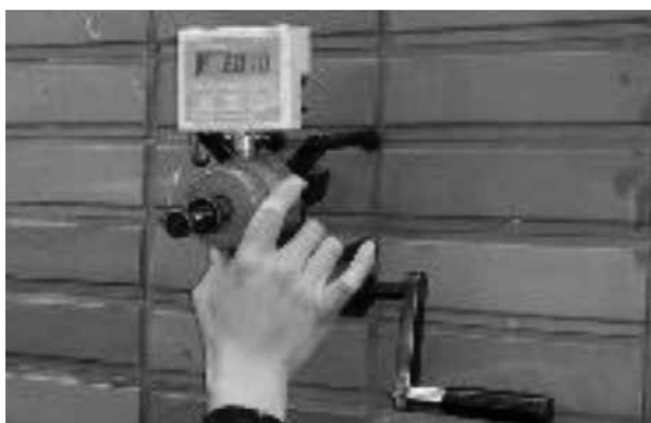
アンカーピン引抜強度試験 (メーカー規格値 1,500N/本以上)
