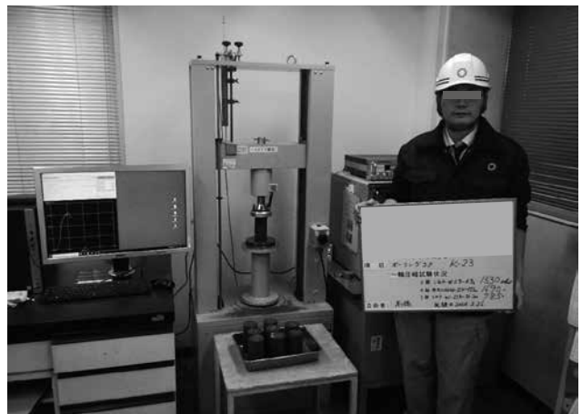
一軸圧縮強度試験
