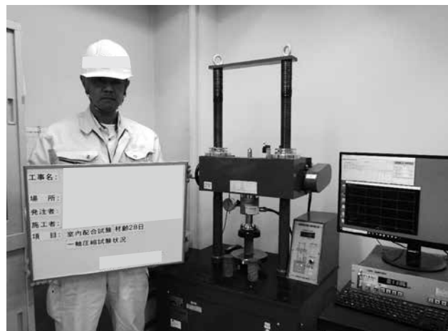
一軸圧縮強度試験
