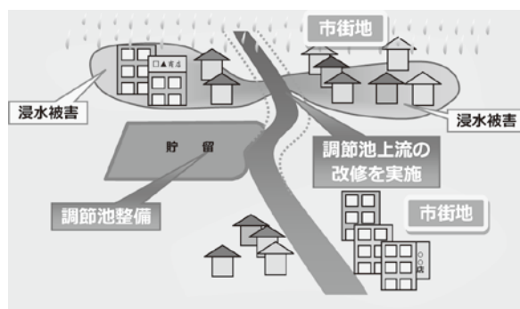
図-3 中・上流部の調節池の先行整備
